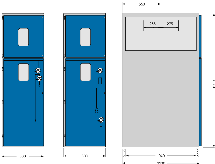
Bild 1: D24 Kabel- und Trafofeld in Front und Seitenansicht
