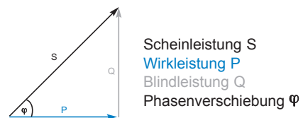
Abb 2: schematische Darstellung Blindleistung induktiver Verbraucher
